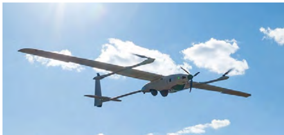
82 pav. Fiksuoto sparno hibridinis VTOL BO
